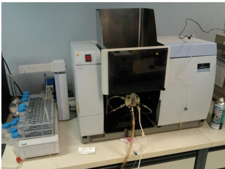
**Figura 15** - Spettrometro ad assorbimento atomico utilizzato per tutte le analisi svolte presso il Laboratorio Sinergo
